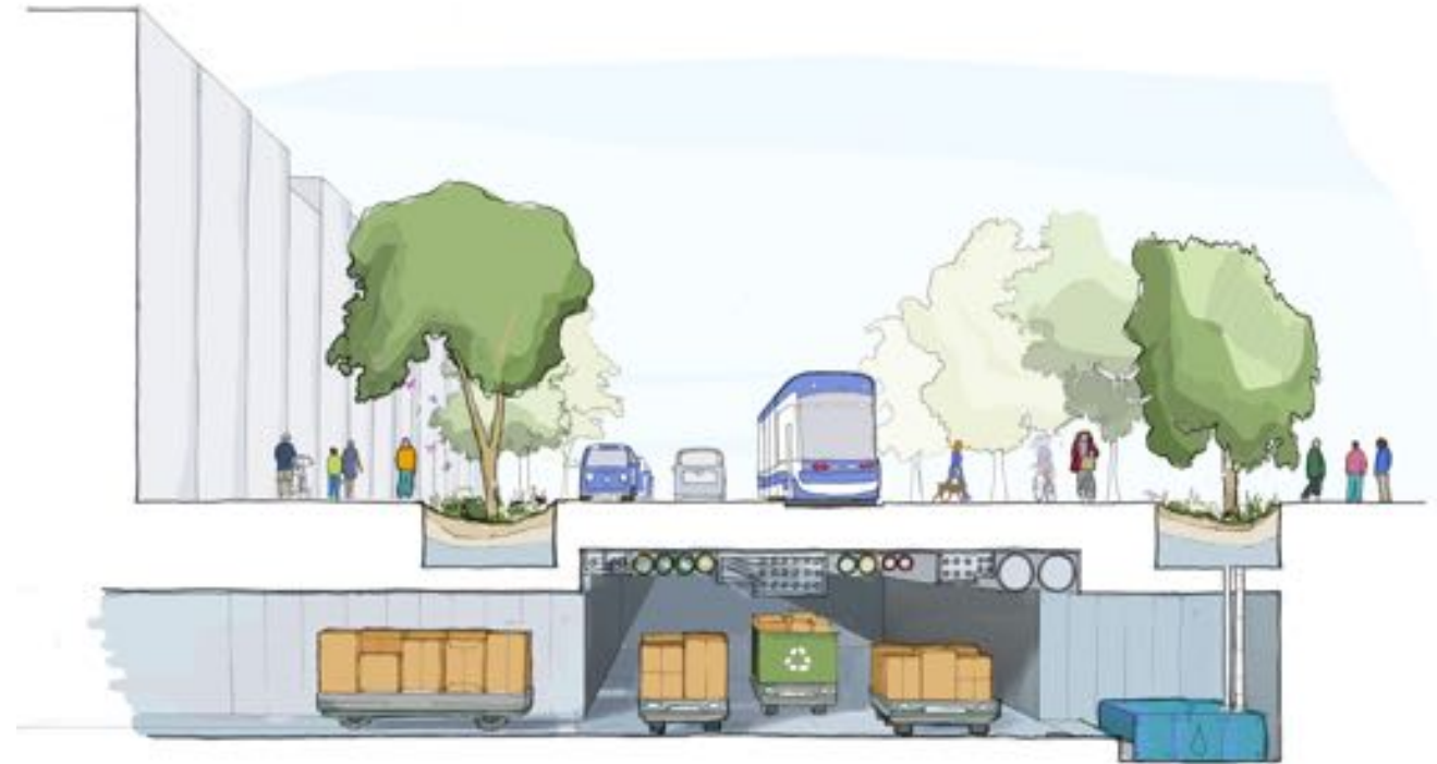
Sidewalk Toronto构想在地下隧道完成分解与运输的垃圾处理系统
